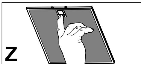
• Nettoyer la hotte avec un chiffon humide et un détergent liquide neutre.
