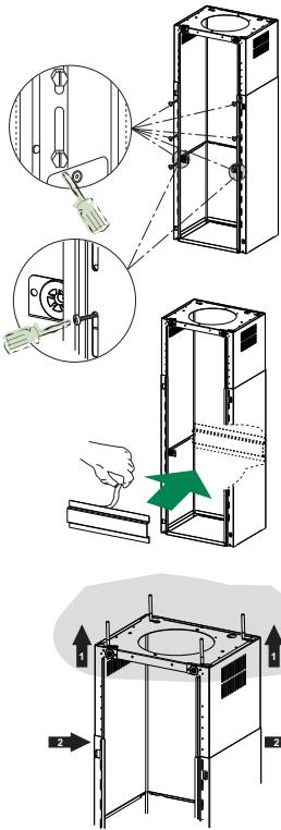
Avant de serrer définitivement les vis, on pourra effectuer des réglages en déplaçant le treillis, en veillant à ce que les vis ne sortent pas du logement de la fente de réglage.
