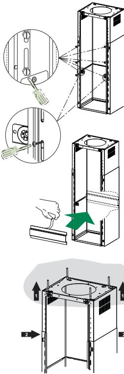
Прежде чем окончательно зафиксировать винты, легким смещением можно отрегулировать положение каркаса; проследите, чтобы винты при этом не вышли из положения в регулировочной прорези.
