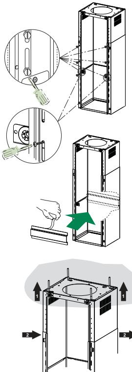
Bevor die Schrauben endgültig festgeschraubt werden, kann durch Verschieben des Gitters reguliert werden. Dabei darauf achten, dass die Schrauben nicht aus dem Sitz der Einstell lang schrauben fallen.
