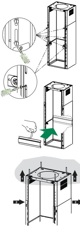
Prima di serrare definitivamente le viti è possibile effettuare delle regolazioni spostando il traliccio facendo attenzione che le viti non escano dalla sede dell'asola di regolazione.
