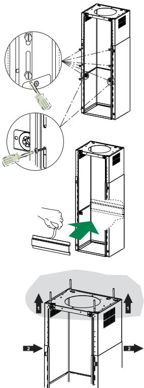
Antes de apertar os parafusos definitivamente, é possível fazer ajustes, rodando a armação e prestando atenção aos parafusos, que não podem sair da sede do orifício oval de ajustamento.
