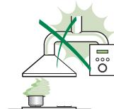
Die Absaughaube mit Hilfe eines Rohrs mit einem Mindestdurchmesser von 120 mm mit dem Rauchabzug verbinden. Der Verlauf des Rauchabzugs soll so kurz wie möglich sein.
