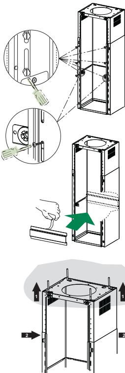
Prima di serrare definitivamente le viti è possibile effettuare delle regolazioni spostando il traliccio facendo attenzione che le viti non escano dalla sede dell'asola di regolazione.
