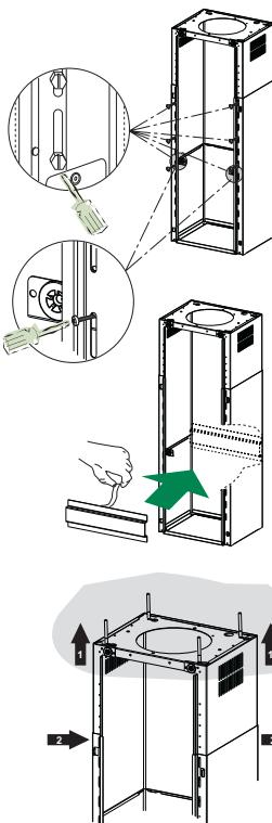
Voordat u de schroeven definitief aanhaalt, kunt u het frame afstellen door het te verplaatsen. Let er daarbij op dat de schroeven niet uit de zitting van het stelgat raken.
