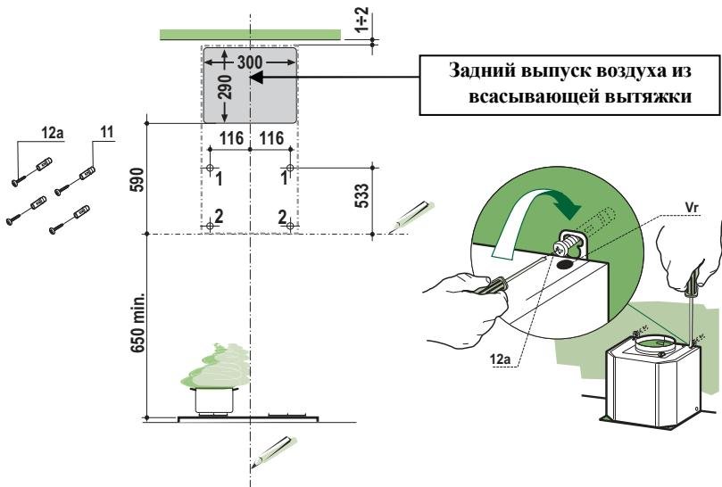
В случае установки фильтрующей вытяжки следует иметь в виду, что между прибором и верхним пределом (потолок или подвесная полка) должно быть расстояние не менее 8-10 см.
