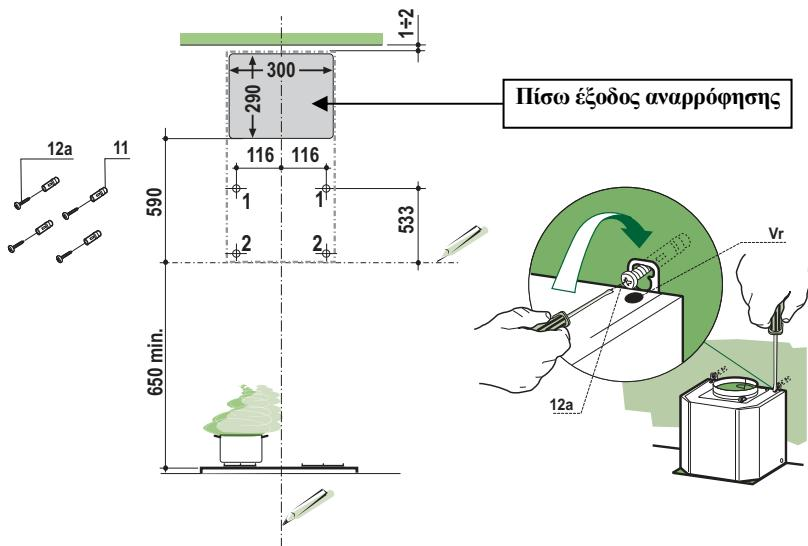
Σε περίπτωση εγκατάστασης του απορροφητήρα με ανακύκλωση, λάβετε υπόψη ότι το πάνω μέρος του απορροφητήρα πρέπει να απέχει από την οροφή ή το ράφι τουλάχιστον 8-10 cm.
