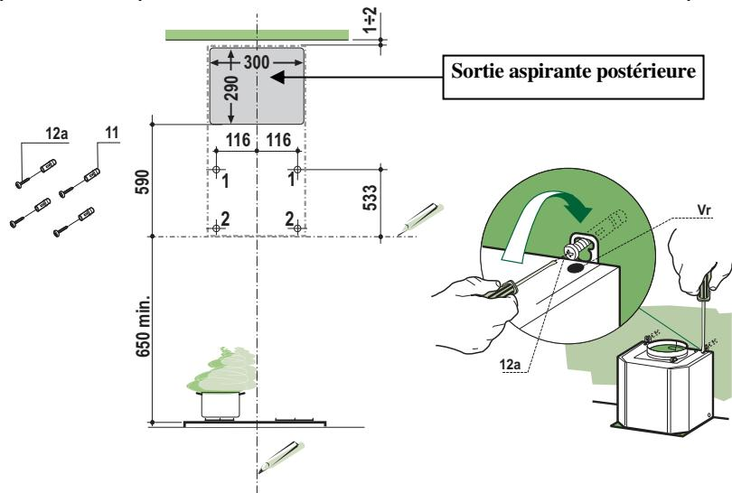
En cas d'installation de la hotte en version filtrante, n'oubliez pas qu'au-dessus de la hotte, la distance de la limite supérieure (plafond ou étagère) doit être d'au moins 8-10 cm.
