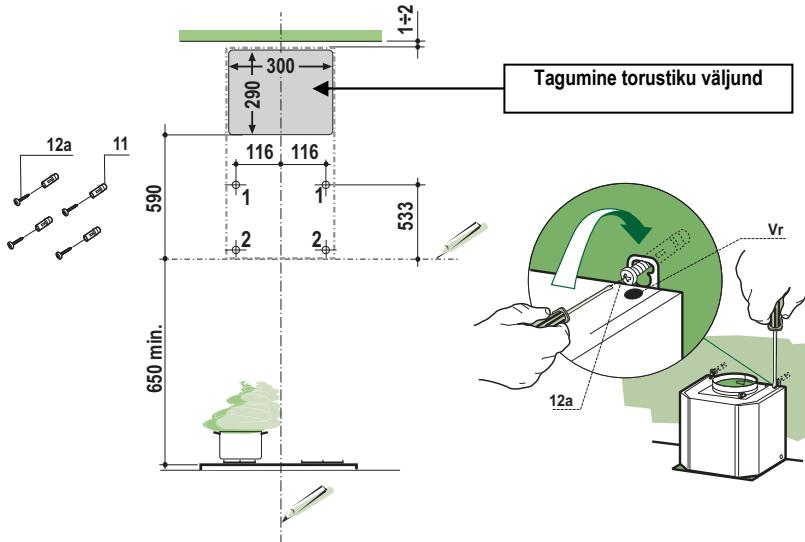
Kui pliidikumm on paigaldatud retsirkulatsiooniga versioonis, pidage meeles, et pliidikummi ülaosa ja selle kohal asuva pinna (lagi või riul) vahel peab olema jäetud minimaalne vahemaa vähemalt 8-10 cm.
