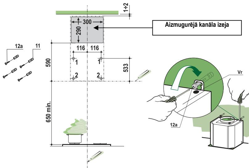
Ja tvaika nosūcējs tiek uzstādīts saskaņā ar atkārtotas pārstrādes tehnoloģijas versiju, tad jāņem vērā, ka jāatstāj vismaz 8-10 cm attālums starp tvaika nosūcēja virspusi un virsmu virs tās (griesti vai plaukts).
