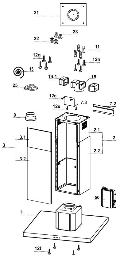
N.B. I Filtri antiodore al Carbone Attivo, necessari solo per installazione in Versione Filtrante, se non in dotazione, devono essere richiesti separatamente.
