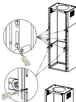
Prima di serrare definitivamente le viti è possibile effettuare delle regolazioni spostando il traliccio facendo attenzione che le viti non escano dalla sede dell'asola di regolazione.
