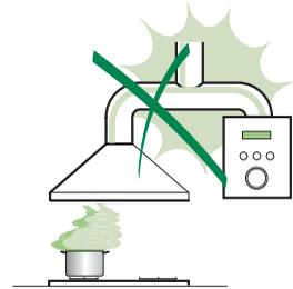
Die Absaughaube mit Hilfe eines Rohrs mit einem Mindestdurchmesser von 120 mm mit dem Rauchabzug verbinden. Der Verlauf des Rauchabzugs soll so kurz wie möglich sein.
